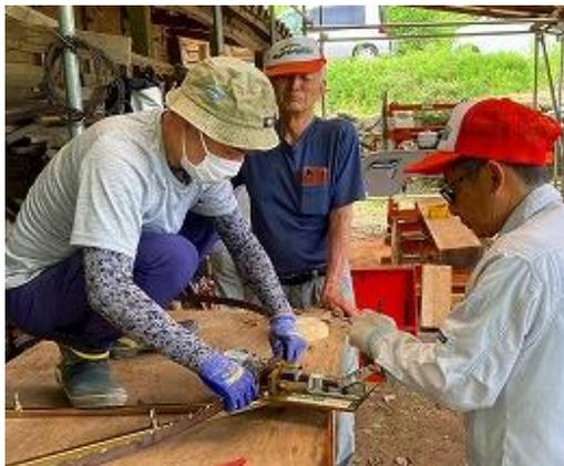
製材機ブレード(刃)のアサリを作る
