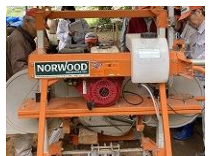
製材機 径69、長さ360㎝まで製材可能
