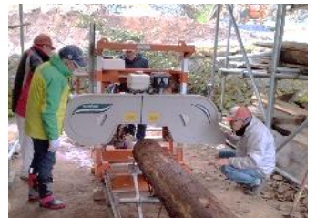
製材機の据え付け試運転 (松波邸)
