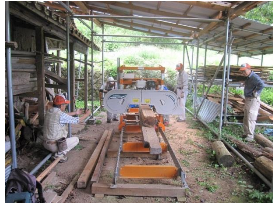
ロゴソール製材機による丸太加工 湯来町麦谷にて (H29. 9. 15)
